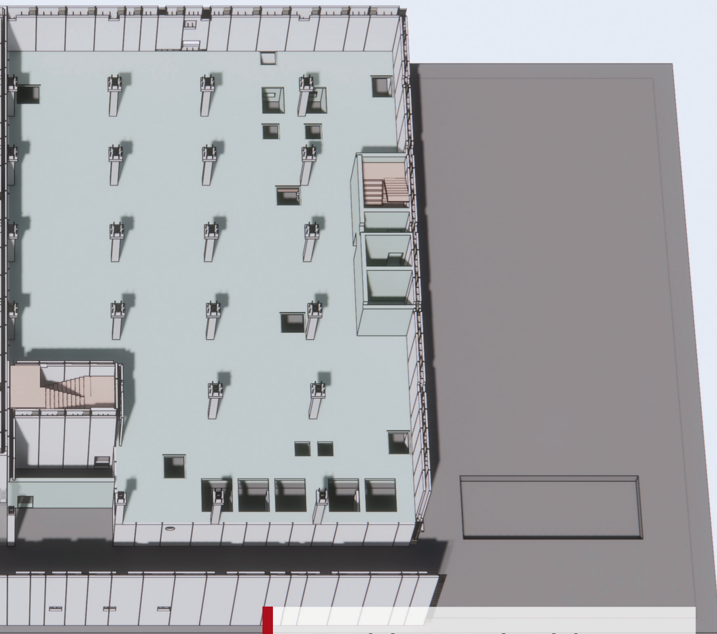
37. 설비동#1 PC기둥 설치
