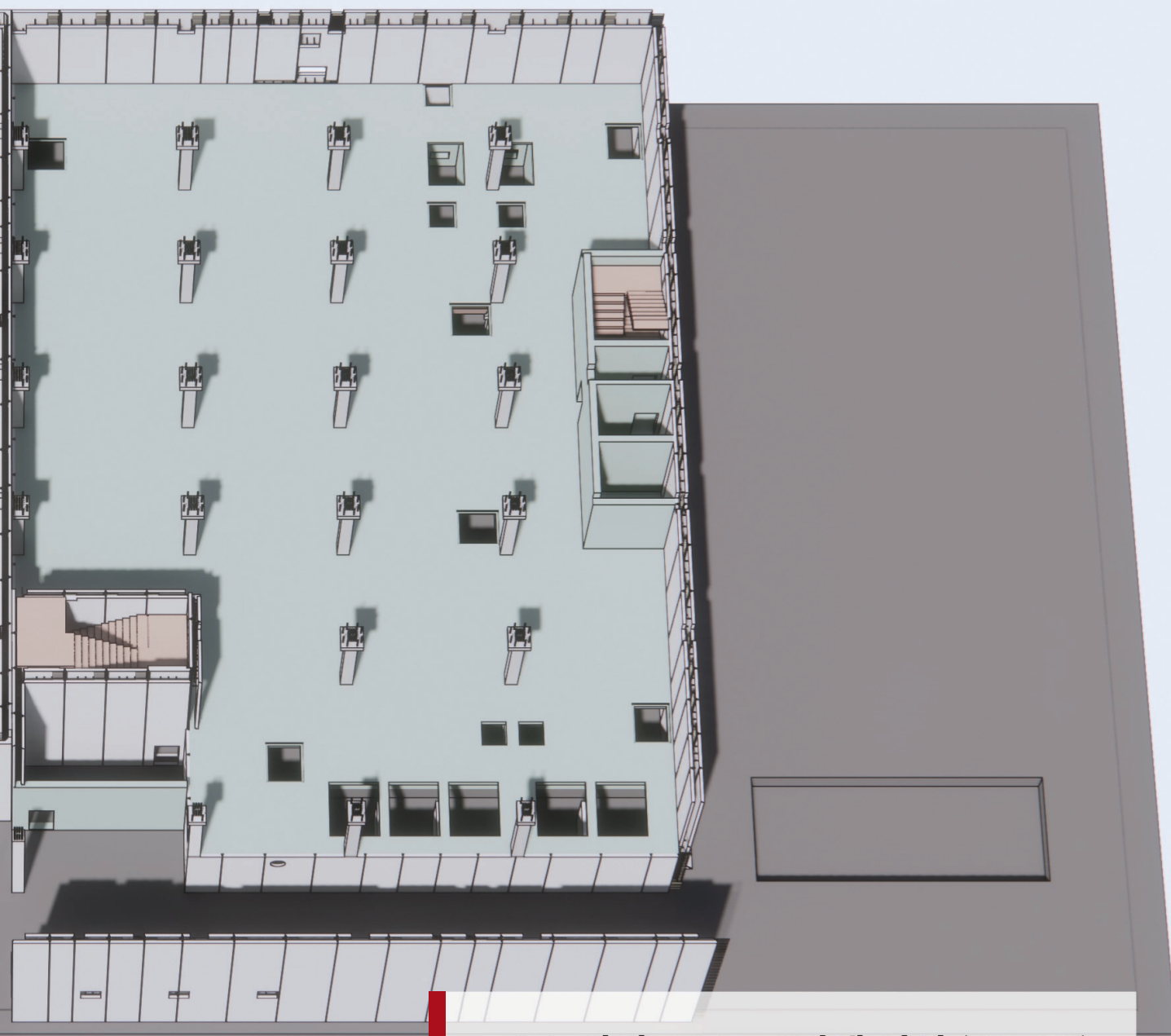
35. 설비동#1 PC벽체 설치 (22,23)
