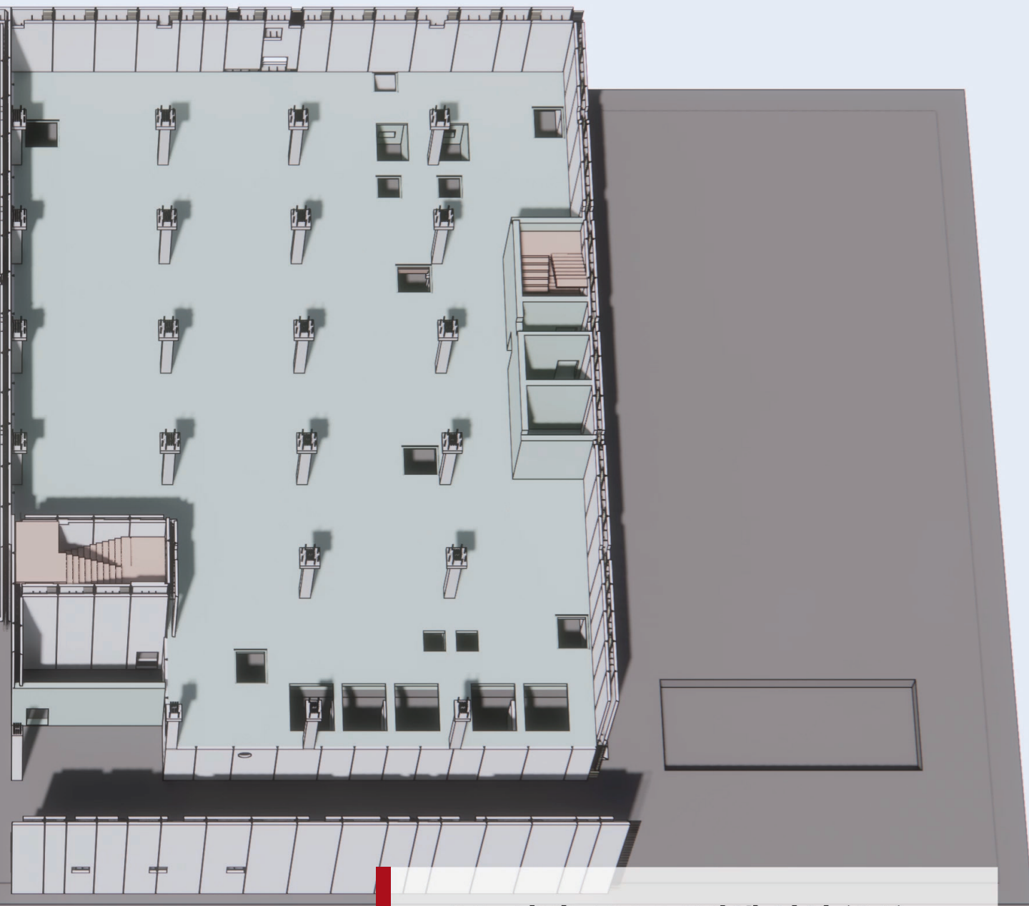
34. 설비동#1 PC벽체 설치 (21)
